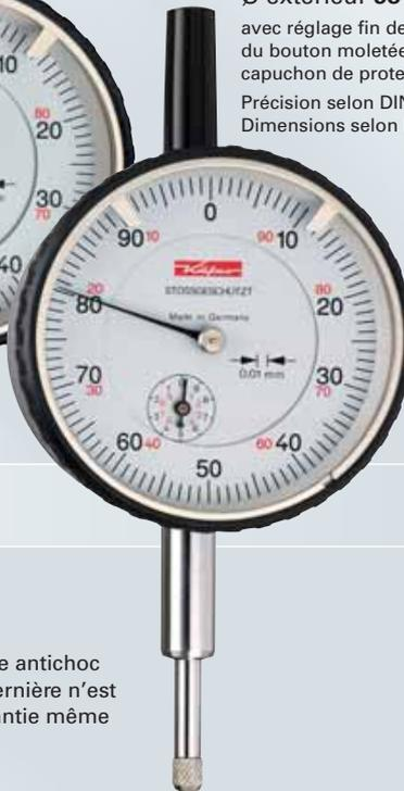
Les comparateurs M 2 SN et M 2 S disposent d'une douille antichoc superposée à la tige, de sorte qu'un choc subi par cette dernière n'est pas transmis au mécanisme. La haute précision reste garantie même en cas d'une utilisation un peu rude.
