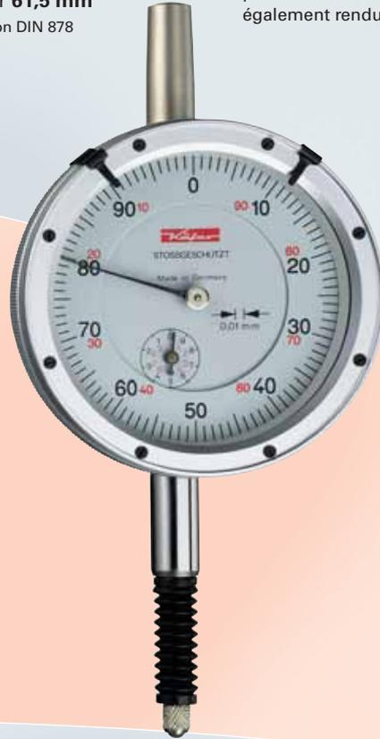
Hermétiquement protégé contre les impuretés. Un soufflet de caoutchouc sur la tige protège la crémaillère contre la projection des liquides et des impuretés. L'étanchéité de la touche supérieure est garantie par le montage d'un capuchon de protection et d'un joint torique. Une conception spéciale de la lunette en métal du comparateur permet d'atteindre une parfaite protection. Le dos du comparateur est également rendu étanche par un joint torique spécial.
